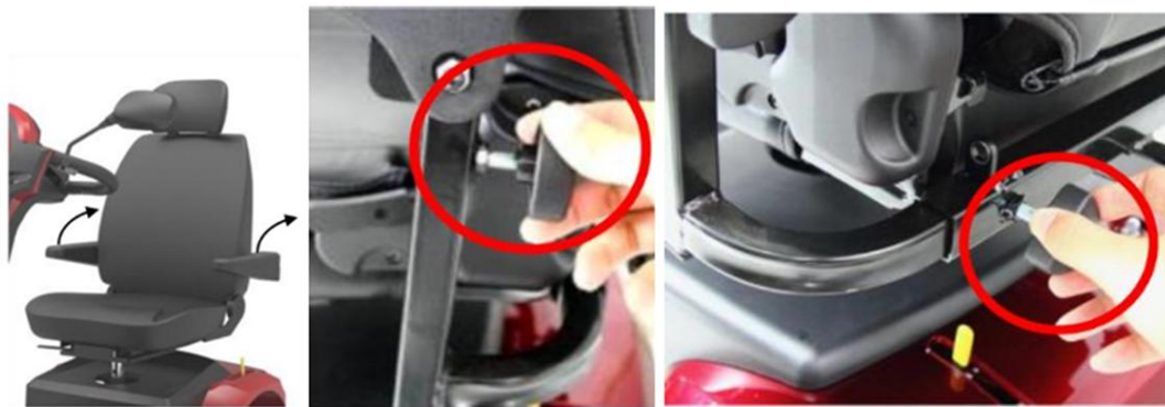
Skuter Vermeiren Carpo 4 z obracaniem (dźwignia obrotu 1) i regulowanym fotelem (nastawa głębokości 2)
